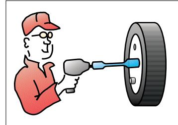
Momenthylsorna är konstruerade för åtdragning av bilhjul med slående mutterdragare. Den långa och smala midjan dämpar överskottskraften i mutterdragaren.
