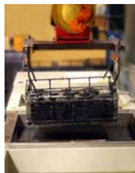
"Ytbeläggningen skall bestå av en kemiskt producerad oxidbeläggning följd av en rotskyddande beläggning. Krom- eller nickelöverdragning får inte användas på maskindrivna hylsor." Ett helautomatiskt system skapar en varaktig svartoxidering och en rotskyddande finish.
