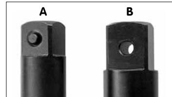
Den utvändiga fyrkanten på Momentos 1/4", 3/8", 1/2" och 5/8" förlängningar, universalknutar och övergångar har lösning med fjädrande stift. Alla större utvändiga fyrkanter har genomgående hål för låspinne.
