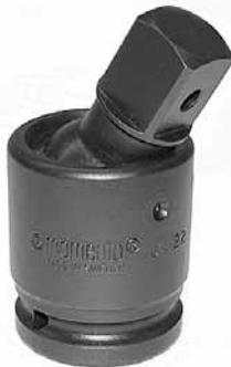
Momentos 1/4", 3/8" och 1/2" universalknutar är fjäderbelastade och kan ställas i önskad vinkel. (Max 30° för kraftverktyg).
