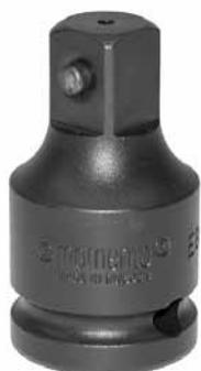
Den utvärdiga fyrkanten på Momentos 1/4", 3/8", 1/2" och 5/8" förlängningar, uni- versalknutar och övergångar har lösning med fjädrande stift. Alla större utvärdiga fyrkanter har genomgående hål för låspinne.
