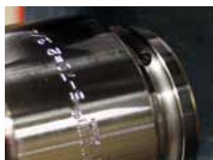
"Maskindrivna hylsor skall vara märkta på ett beständigt och läsbart sätt". Rullmärkning är tillverkaren är i praktiken den enda metod som svarar upp mot detta krav.
