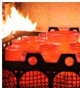
En mångsidig värmebehandlingsavdelning fullt utrustad för seghärdning, mjukglödning, sätthärdning, nitrokarburering, nitrering och karbonitrering säkrar de rätta egenskaperna för varje produkt.
