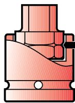
Insatsmejslarna låses med en spetsig skruv mot ett v-format spår i insatsmejselns hörn. Vid behov kan skruven säkras ytterligare med gänglåsningsmedel.
