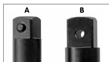
Den utvändiga fyrkanten på Momentos 1/4", 3/8", 1/2" och 5/8" förlängningar, universalknutar och övergångar har låsning med fjädrande stift. Alla större utvändiga fyrkanter har genomgående hål för låspinne.
