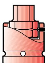
Insatsmejslarna låses med en spetsig skruv mot ett v-format spår i insatsmejselns hörn. Vid behov kan skruven säkras ytterligare med gänglåsningsmedel.
