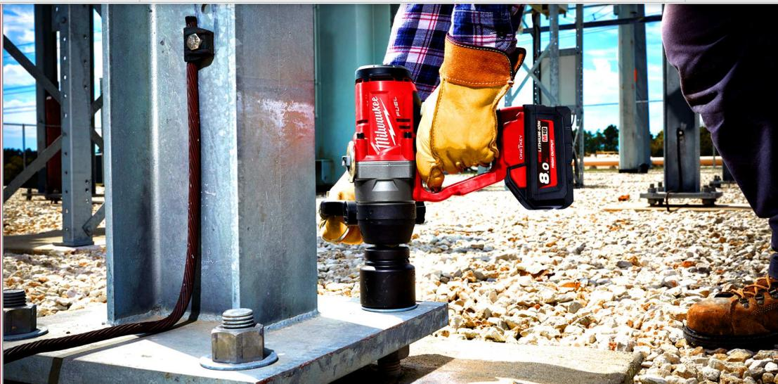
Novi udarni stezač je **prvi** akumulatorski 1" udarni stezač na svijetu. M18 ONEFHIWF1 ima vrlo kompaktnu konstrukciju za savršeno rukovanje na svim radnim mjestima i uvjetima rada. M18 FUEL 1" udarni stezač postiže **2400 Nm** steznog momenta, snaga kojom može odvrnuti **M42** vijke.
