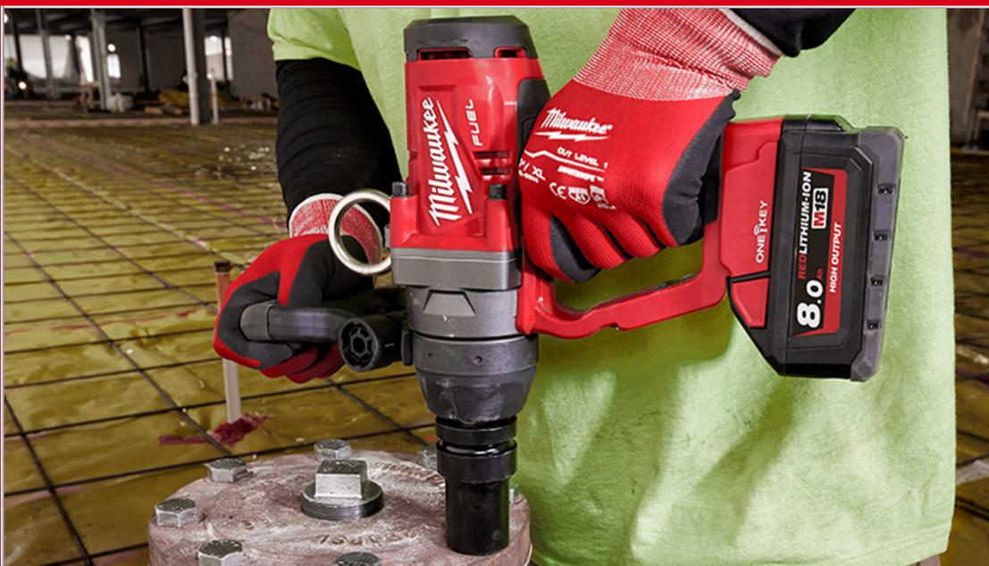
**DRIVE CONTROL™** sistem omogućava korisniku jednostavni odabir 4 različite postavke brzine, broja udaraca i steznog momenta za maksimalnu svestranost. Integrirani senzor kontrole udaraca poboljšava konzistentnu ponovljivost odabranih postavki.
